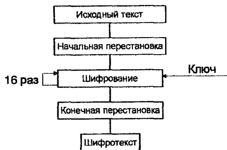
Рис. 16. Схема алгоритма DES.
