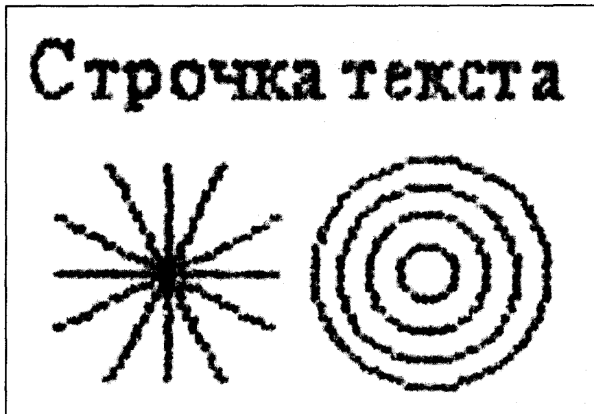
Рис. 1.12. Матричный 9-игольчатый принтер 120 на 144 dpi
