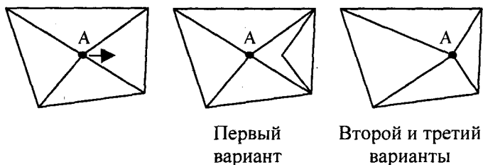
Рис. 4.8. Результат изменения координат одной вершины
