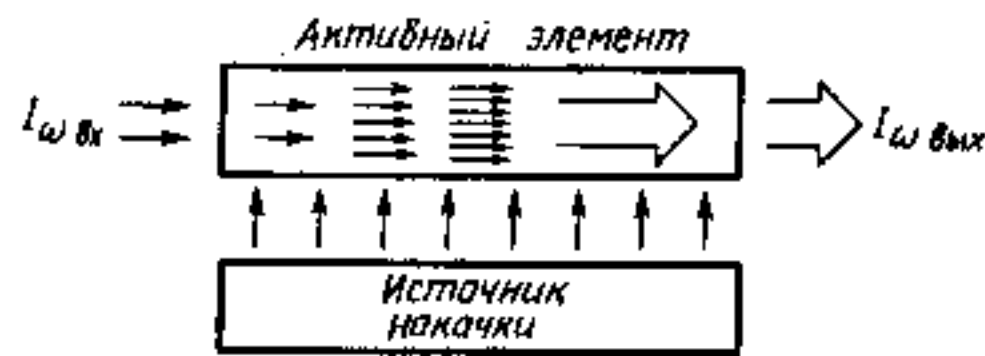
Рис. 2.3. Общая схема квантового усилителя
