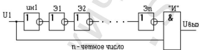
Рис. 4.3. Формирователь коротких импульсов с использованием элементов логики
