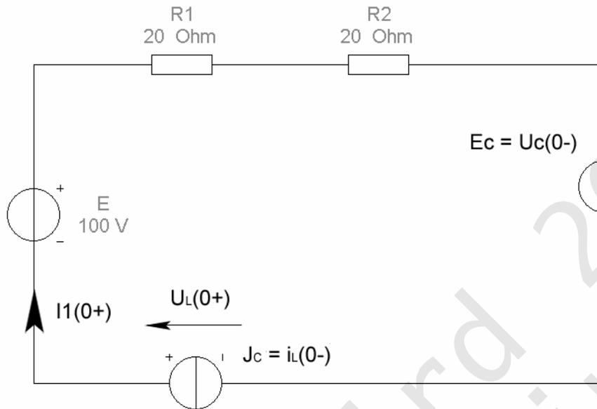
$i_1(0_+) = i_1(0_-) = 4.545\text{ A}$ , по закону коммутации.
