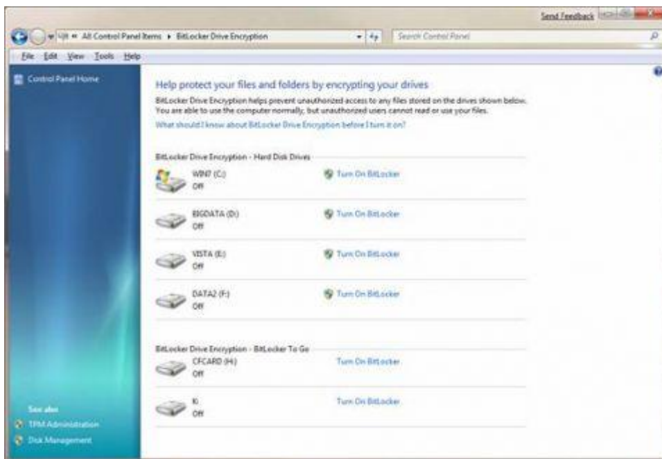
Рисунок 3: В Windows 7 у вас есть возможность использовать BitLocker шифрование на съемных и фиксированных носителях
